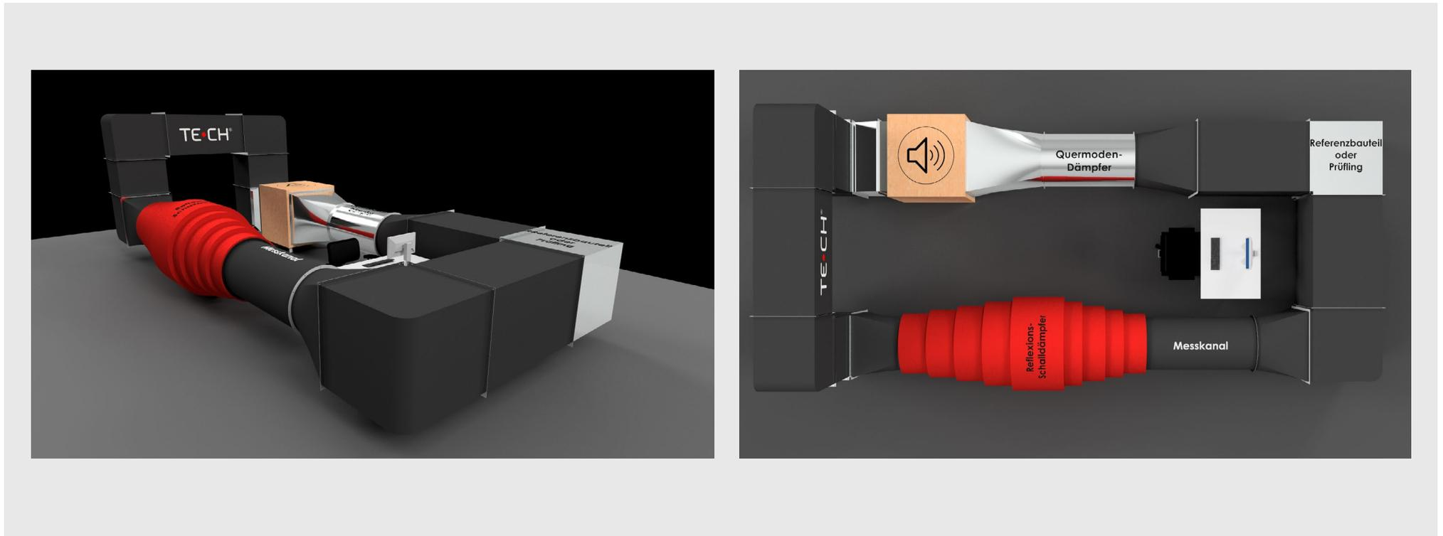
**Mit unserem Prüfstand testen wir luftführende Bauteile auf Einfügungsdämpfung, Druckverlust und Strömungsverhalten.**
